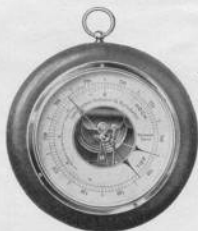
Barometer in runden Holzrahmen mit Kartonskala. (Drehbare Doppelskalen: „Hoch und Tief“.)
