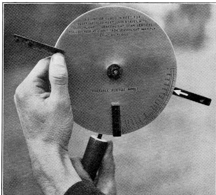
METEOROLOGICAL OFFICE PORTABLE ALIDADE
