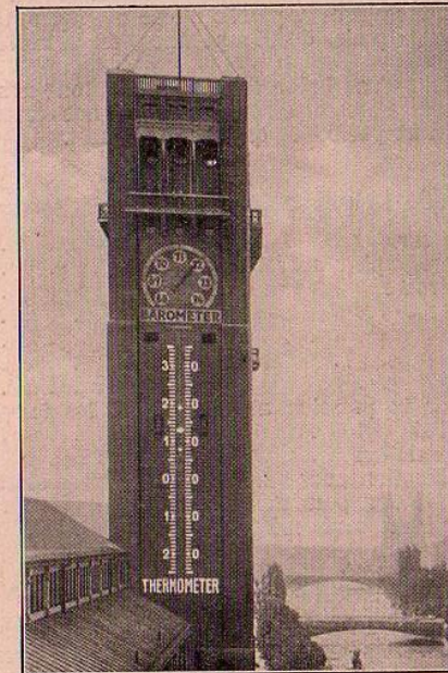
Thermomètre géant construit par la maison R. FUESS avec index de maxima et minima, fixé à la tour du „Musée allemand“ à Munich. Hauteur de la graduation 22 m, largeur 2 m.
