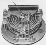
Barometer-Werk mit Doppel-Luftdöse behufs größerer Empfindlichkeit. 31-33.
