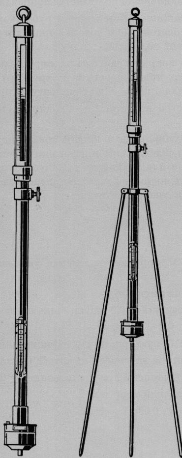
К важнейшим измерениям в метеорологии относится точное определение давления воздуха. Из числа целого ряда применяемых барометров особенно хорошо оправдал себя станционный барометр.
